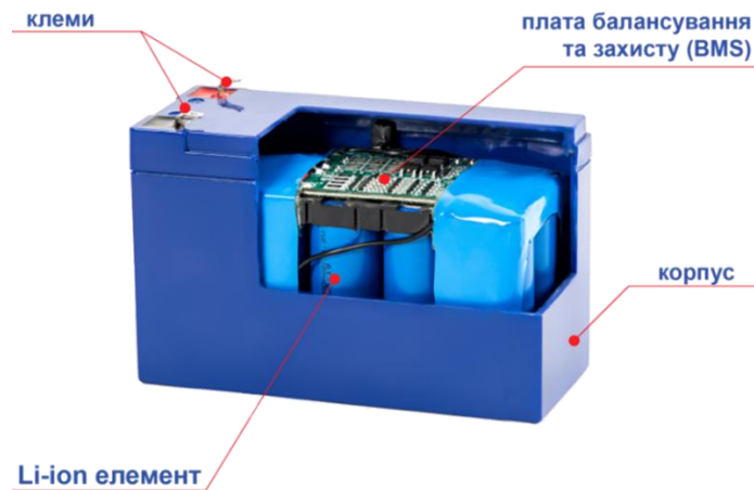
Рисунок 2.6 – Будова Li-ion акумулятора
