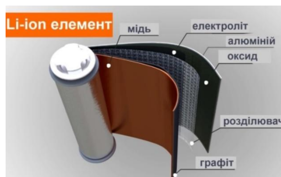
Рисунок 2.5 – Будова Li-ion елемента
