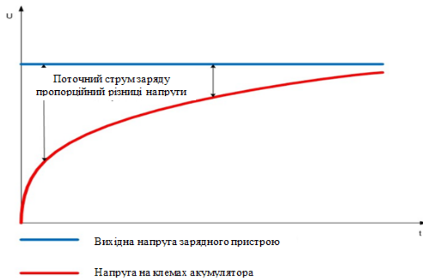
Рисунок 2.12 – Процес зарядки свинцево-кислотної батареї стабільною напругою
