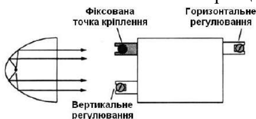
Рисунок 6.12 – Принцип регулювання напрямку світла фари
