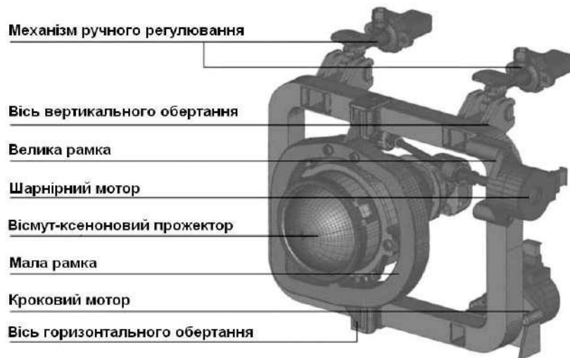
Рисунок 6.29 – Механічна конструкція системи ASF
