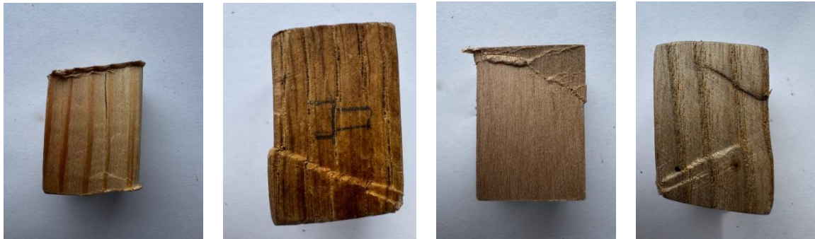
Рисунок 3.4 – Загальний вигляд зразків різних порід деревини після випробування на стискання:
