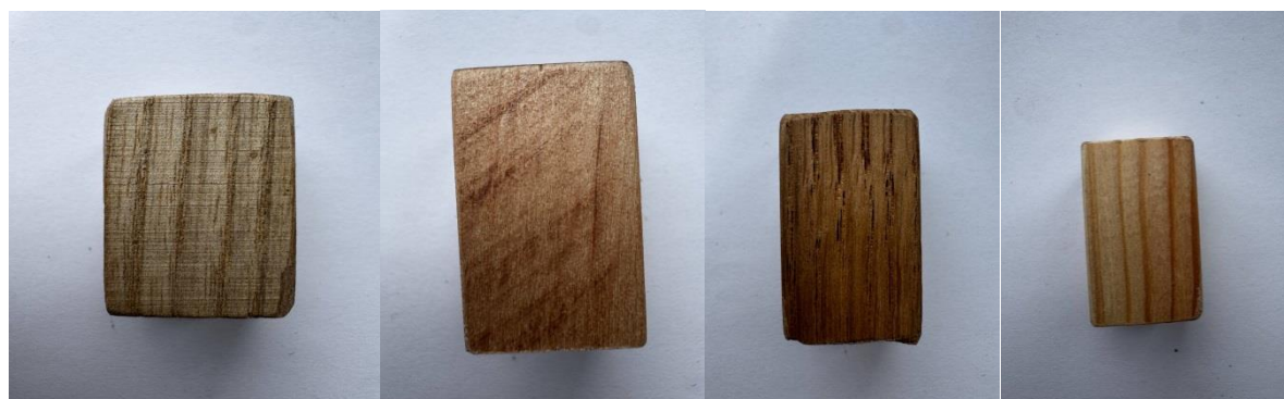
Рисунок 3.2 – Загальний вигляд зразків перед випробуванням на стискання:
