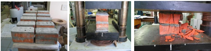
Рис. 4. Підготовка, встановлення та руйнування дослідного зразка на пресі
