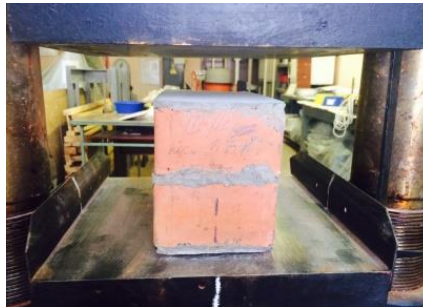
Рис. 1. Випробування дослідного зразка за класичною методикою на стандартному цементно-піщаному розчині
