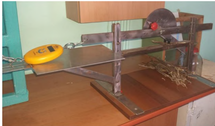
Рисунок 3.13 – Експериментальна установка для визначення зусилля різання зразків гички
