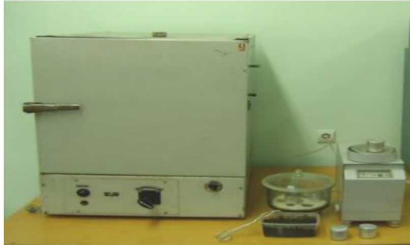
Рисунок 3.1 – Лабораторні прилади і обладнання для визначення вологості гички та її вологовмісту:
