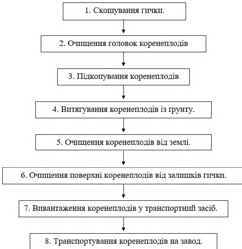
Рисунок 2.1.- Схема технологічного процесу збирання цукрових буряків
