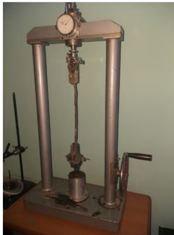
Рисунок 3.7 – Загальний вигляд установки для визначення розривного навантаження гички цукрових буряків.
