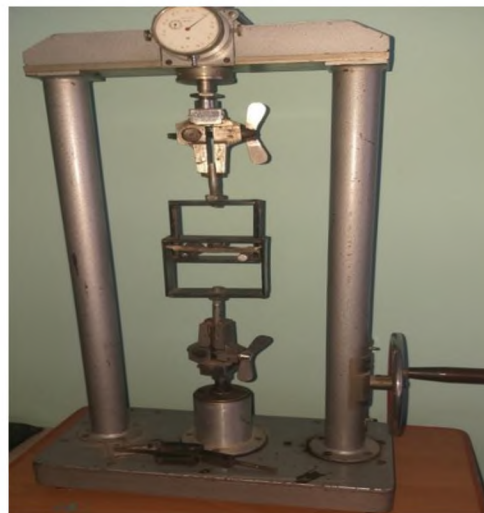
Рисунок 3.10 – Екстензометр із пристроєм для проведення дослідів згину зразків гички.
