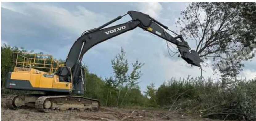
Рисунок 1.4 Робота екскаватора із гідравлічними ножицями (а) та комп'ютерна модель гідравлічного секатора із захватом (б)
