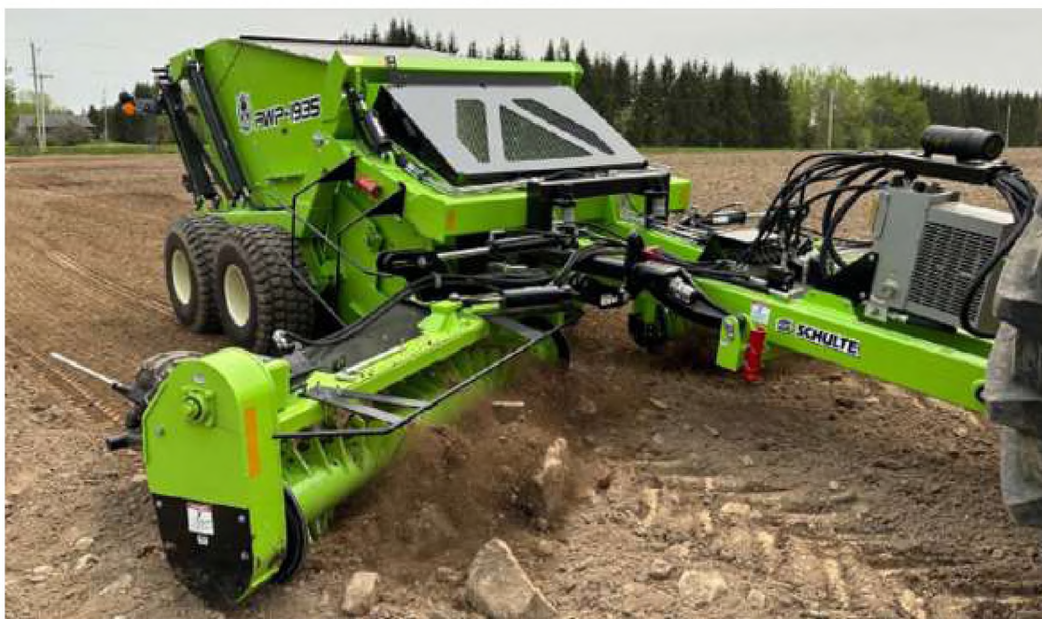
Рисунок 1.1 Фото роботи підбирача-накопичувача каміння RWP-1935 Spartan Rock Windrower
