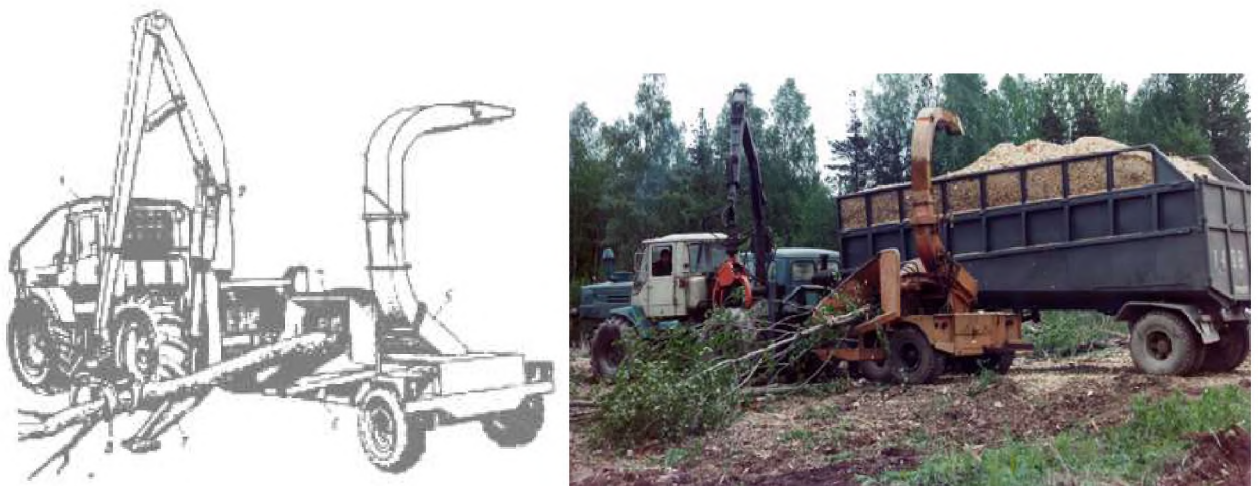
Рисунок 1.8 Пересувна рубальна установка УРП-1: 1 - базовий трактор Т-150ДО; 2 - гідроманіпулятор; 3 - відвідний трубопровід; 4 - механізм подачі; 5 - ножовий диск; 6 - причіпна платформа; 7 - опори; 8 - грейферний завантажувач
