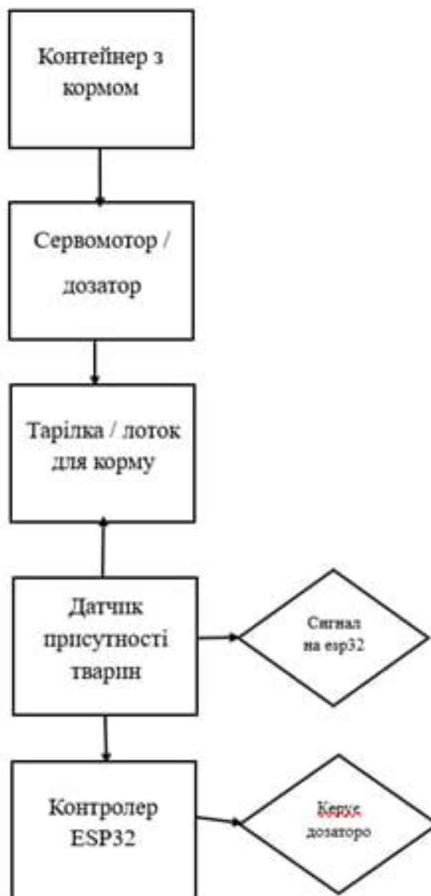
Рисунок 1.6 – Схема автоматичної годівниці для домашніх тварин із функцією програмування
