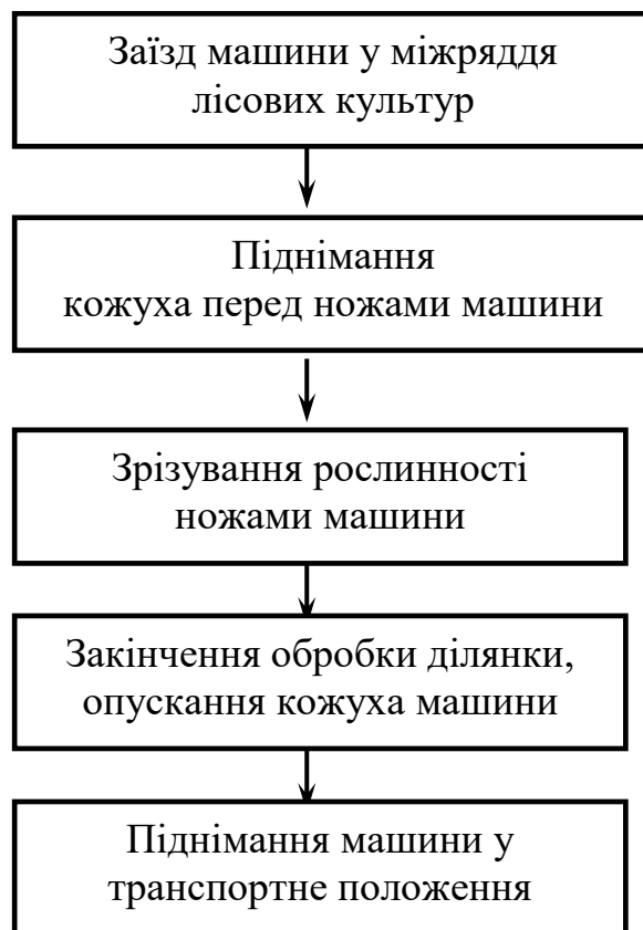
Рисунок 2.1 – Структурна схема машини для зрізування чагарникової та деревної рослинності
