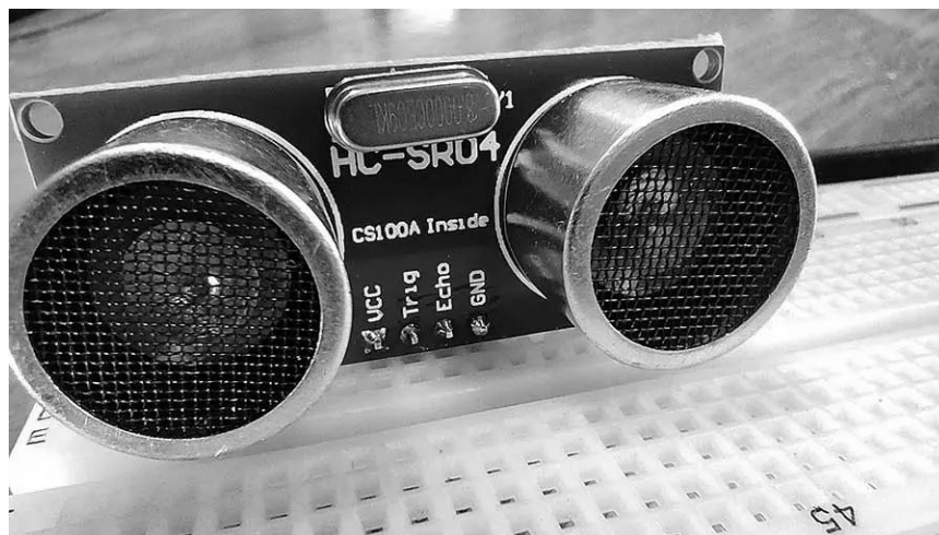
Рисунок 2.3 – Ультразвуковий датчик для генерації ультразвукових хвиль при виявленні руху [22]
