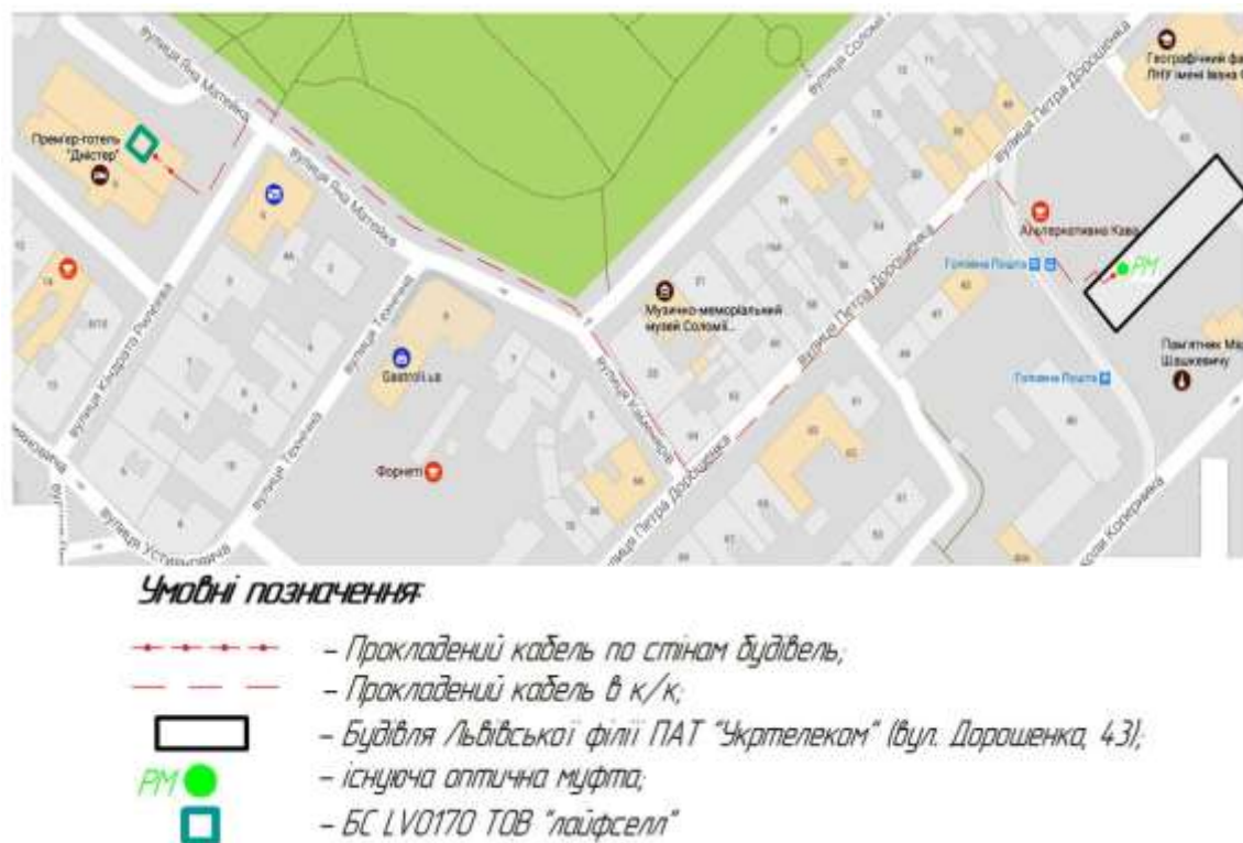
Рисунок 4.5 – Схема прокладання кабелю ВОЛЗ
