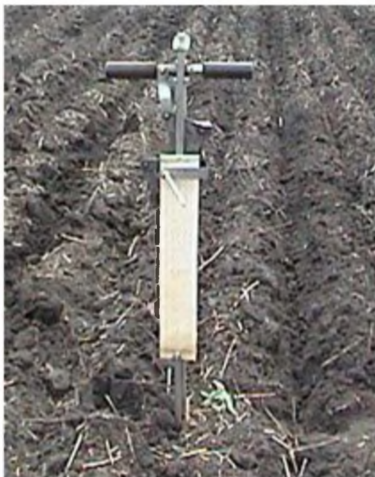
Рисунок 4.1 - Визначення твердості ґрунту твердоміром Ревякіна.
