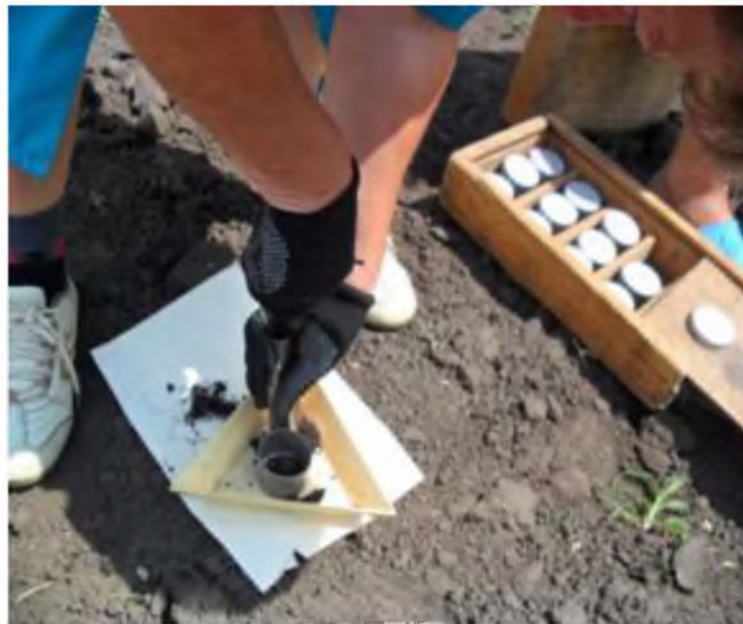
Рисунок 4.5 - Взяття проби ґрунту під час проведення експериментальних досліджень з визначення показників якості виконання технологічного процесу обробітку ґрунту
