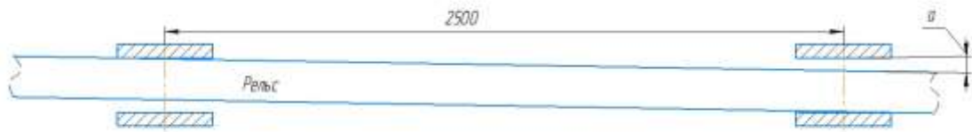
Рисунок 2.2 – Зміщення коліс щодо рейки внаслідок перекосу крана
