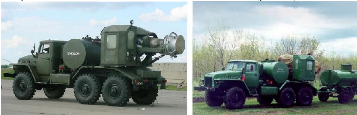
Рис. 8.2. Теплова машина для спеціальної обробки техніки ТМС-65
