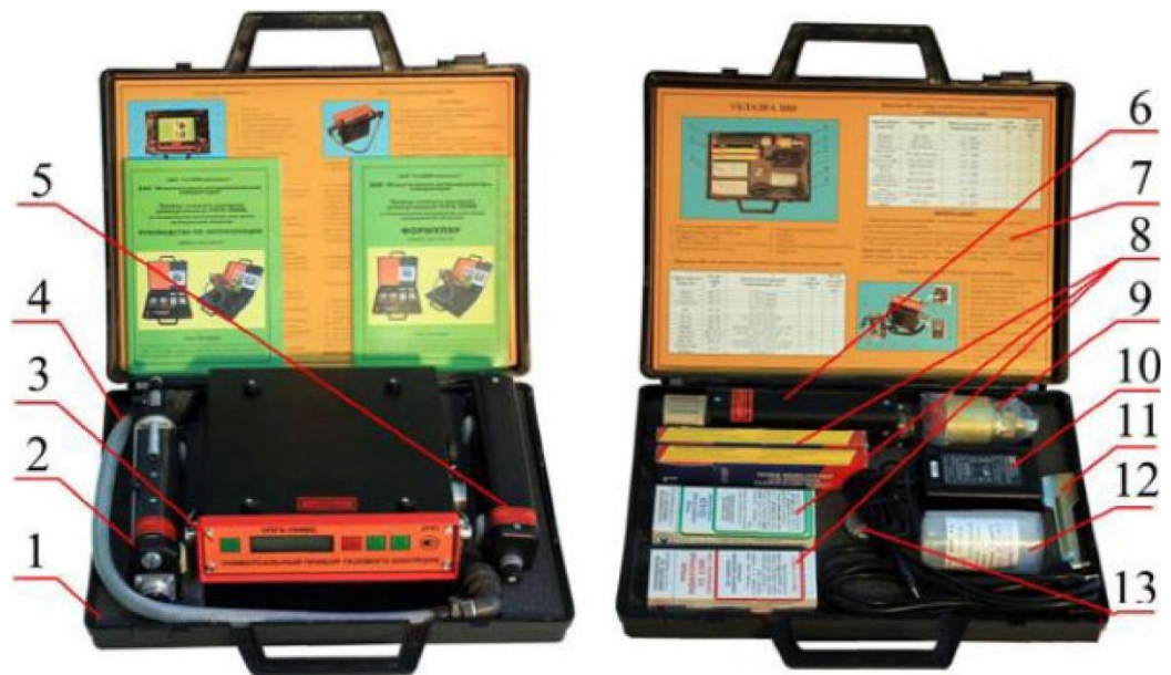
Рис. 8.6. Універсальний прилад газового контролю УПК-ЛІМБ: 1 -упаковка приладу (кейс); 2 - блок пробовідбору (БПВ); 3 - блок керування (БК); 4 - пневмоелектрокабель; 5 - блок вимірювальний (БВ); 6 - блок отруйних речовин (БОР); 7-упаковка ЗІП (кейс); 8 - трубки індикаторні (ТІ); 9 - пристрій імітаційний; 10- пристрій живлення (ПЖ); 11 - лопатка; 12 - комплект імітаційної рецептури КІР-1А; 13 – піддон
