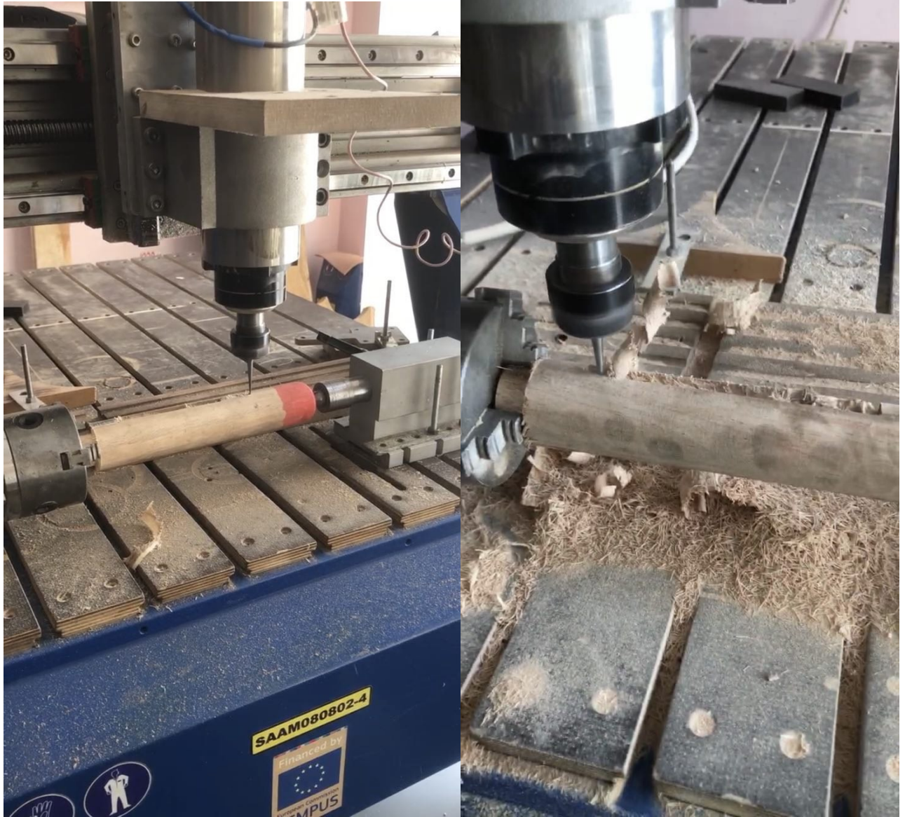
Рисунок 5.4 – Виготовлення макету на верстаті з ЧПУ
