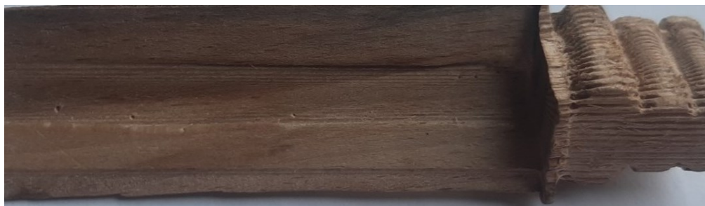
Рисунок 5.5 – Результат обробки дерев'яного макету лопатки заготурбінного двигуна
