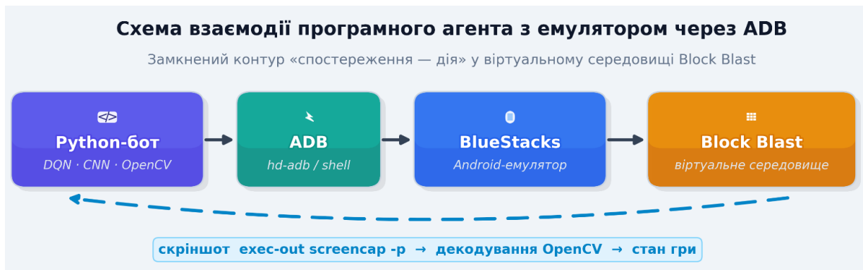
Рисунок 1.2 – Схема взаємодії програмного агента з емулятором через ADB
