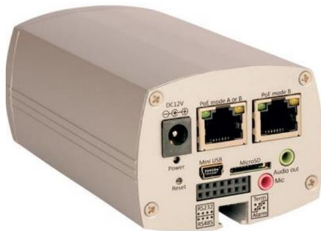
Рисунок 1. 5 – Зовнішній вид Sigrand POE switch
