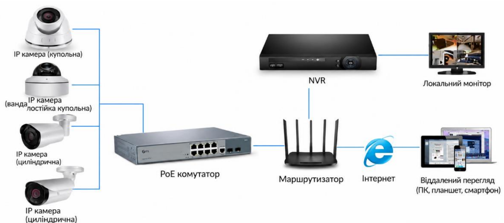
Рисунок 1.3 – Загальне застосування PoE комутатора 8
