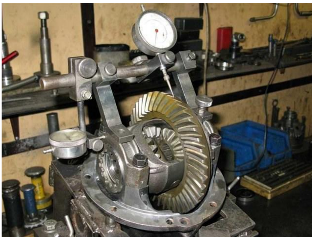
Рисунок 3.3 - Процес регулювання редуктора заднього моста
