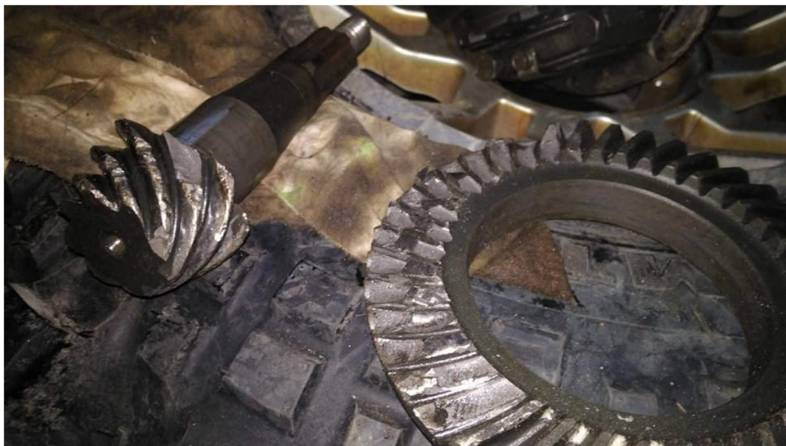
Рисунок 3.1 - Руйнування ведучої та веденої шестерні редуктора заднього моста
