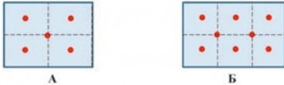
Рисунок 3.6. Схема відбору точкових проб партії насіння, які зберігаються на складах чи майданчиках: А- площа складу до 100 м 2 , Б -
