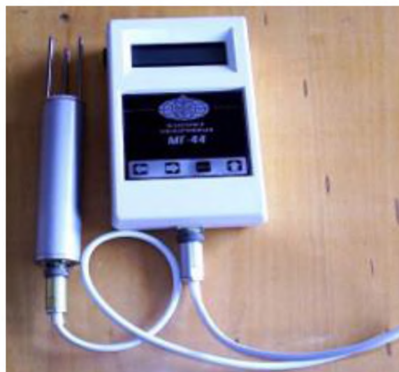
Рисунок 3.2 Електронний вологомір МГ-44 визначення для вмісту вологи в досліджуваних матеріалах
