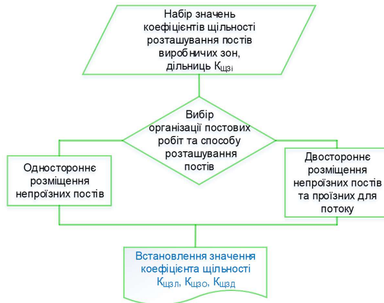
Рисунок 3.3 – Схема алгоритму встановлення значень коефіцієнтів щільності розміщення постів виробничого осередку (зони, діляниці)
