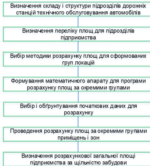
Рисунок 3.1 – Схема лінійного алгоритму загального розрахунку площ дорожньої станції технічного обслуговування
