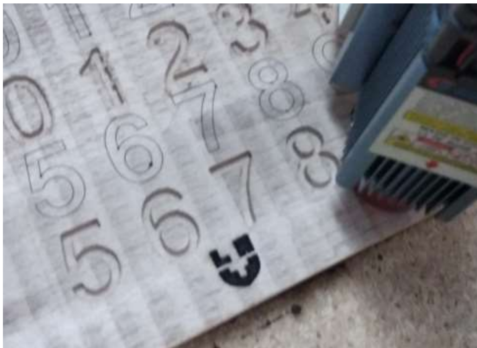
Рисунок 4.8 – Результат лазерного гравіювання зображення на деталі
