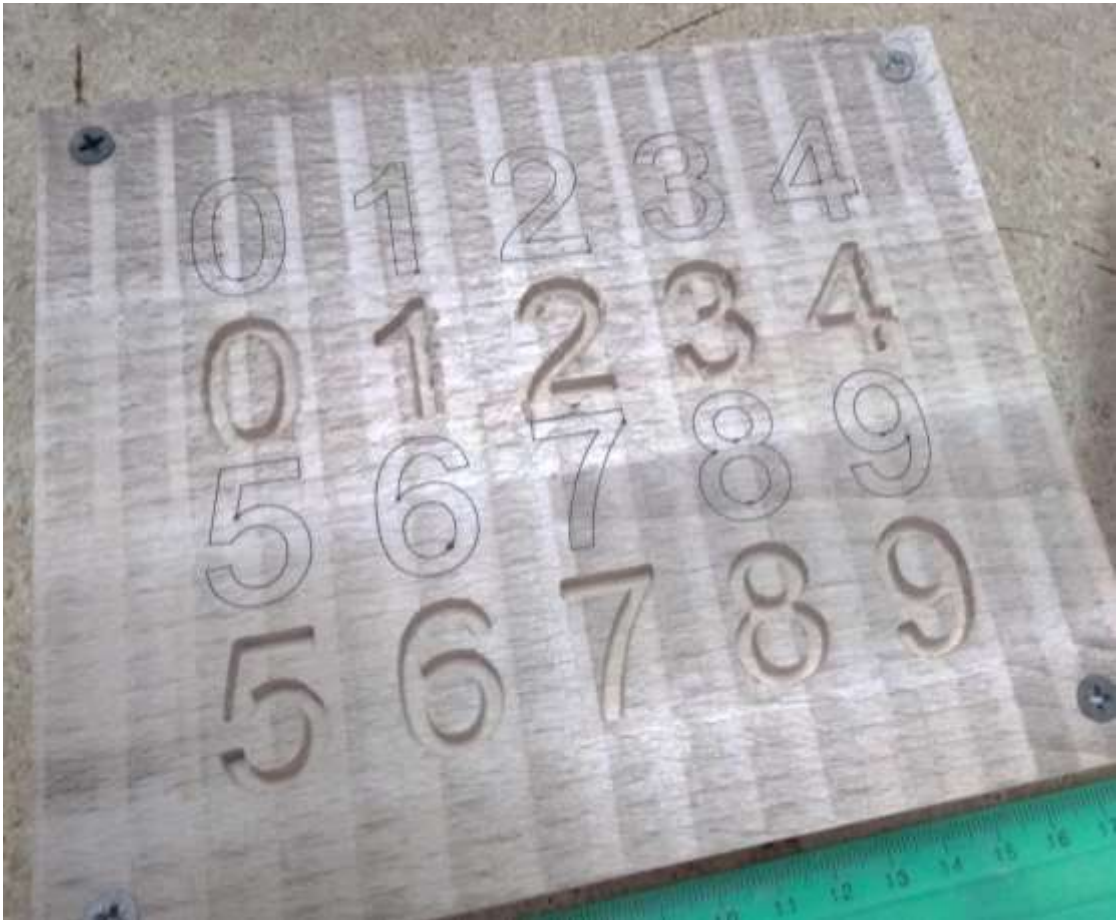
Рисунок 4.6 – Результат лазерного різання контурів цифр на деталі
