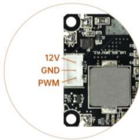
Рисунок 2.3 – Фрагмент плати модуляції 12В / ШІМ на лазерній головці SCULPFUN S9.
