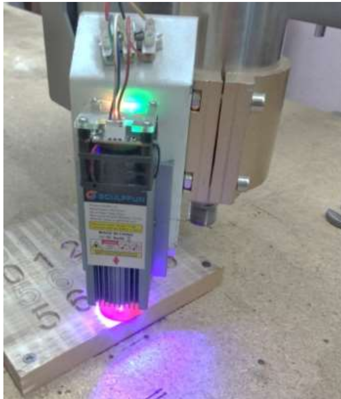
Рисунок 4.7 – Процес лазерного гравіювання зображення на тестовій деталі
