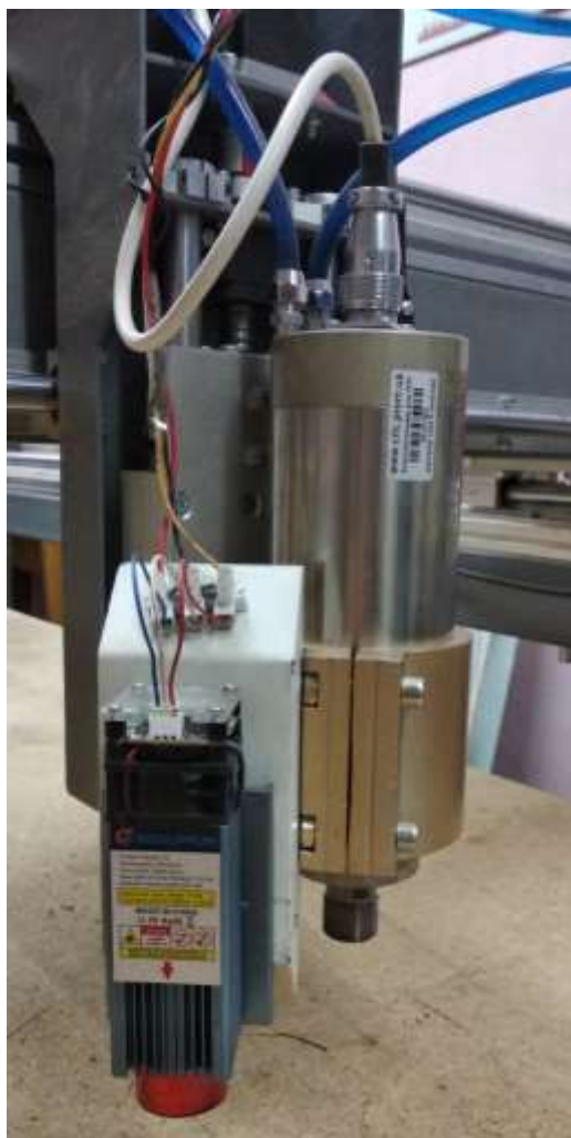
Рисунок 3.10 – Встановлений на фрезерний верстат з ЧПК модуль для здійснення лазерної обробки.
