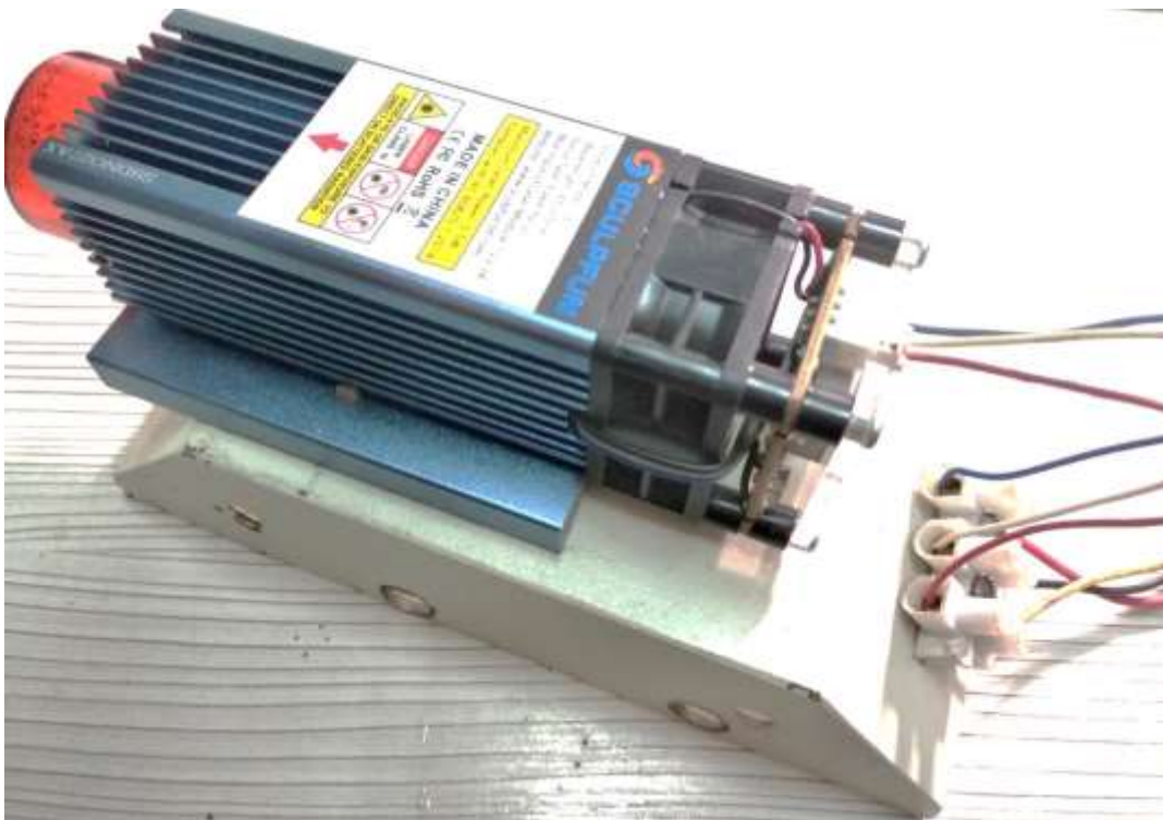
Рисунок 3.10 – Виготовлений кронштейн з змонтованою на ньому лазерною головкою з контактором.
