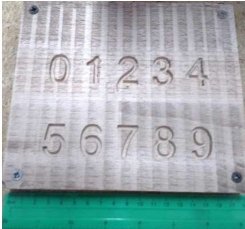
Рисунок 4.3 – Результат фрезерного оброблення тестової деталі
