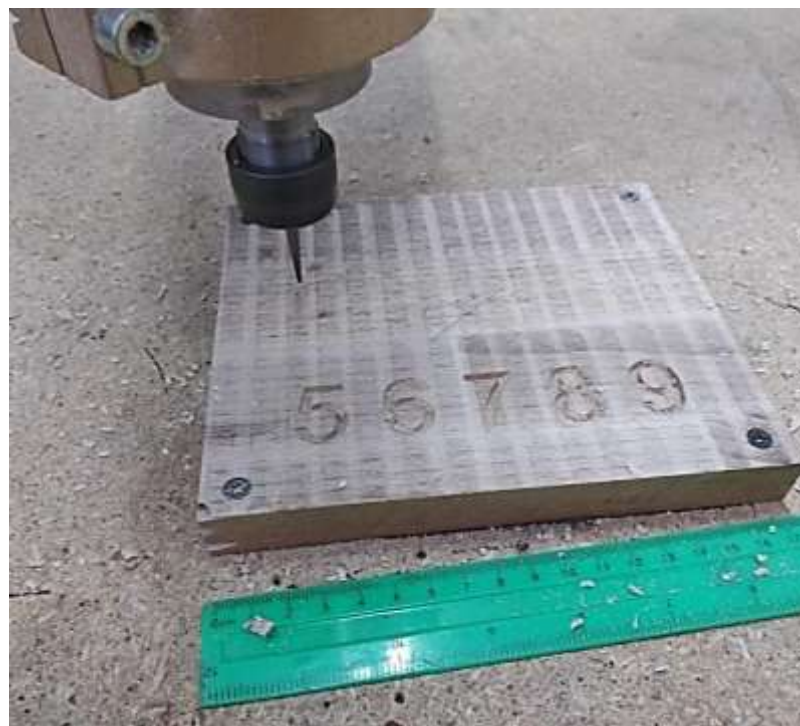
Рисунок 4.3 – Процес фрезерного оброблення тестової деталі
