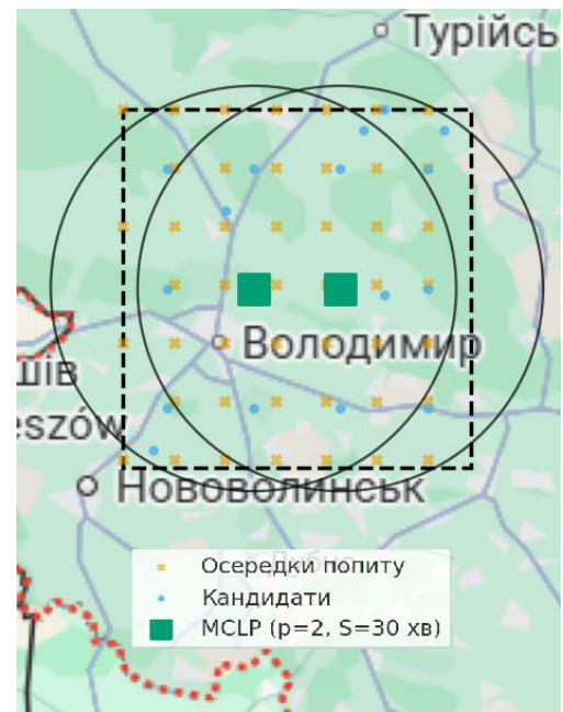
Рисунок 3.8 – Вибрані локації ПКТС за MCLP ( p=2 , 30 хв) та 30-хв зони покриття, м. Володимир
