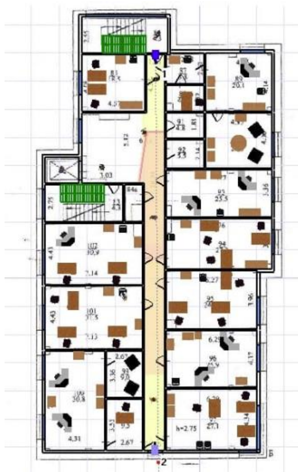
Рисунок 6.9 – План будівлі з довгим коридором
