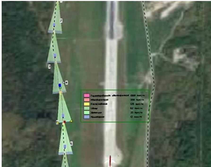
Рисунок 8.3 – Приклад встановлення камер за схемою «один за одним»
