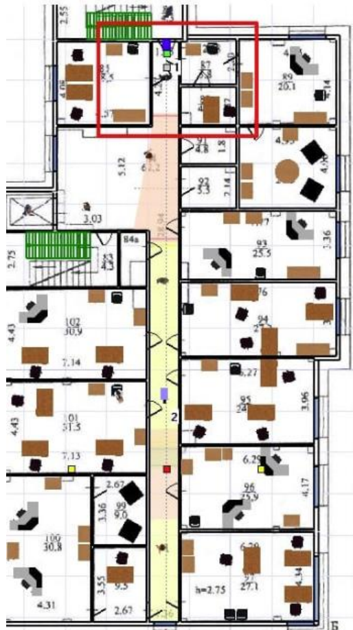
Рисунок 6.11 – Наявність «мертвої зони» за схемою встановлення камер «одна за одною»
