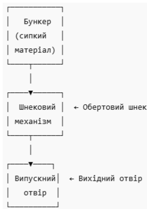
Рисунок 1.5 Схема роботи шнекового дозатора
