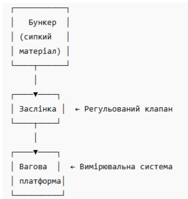
Рисунок 1.2 Принцип роботи гравітаційного дозатора
