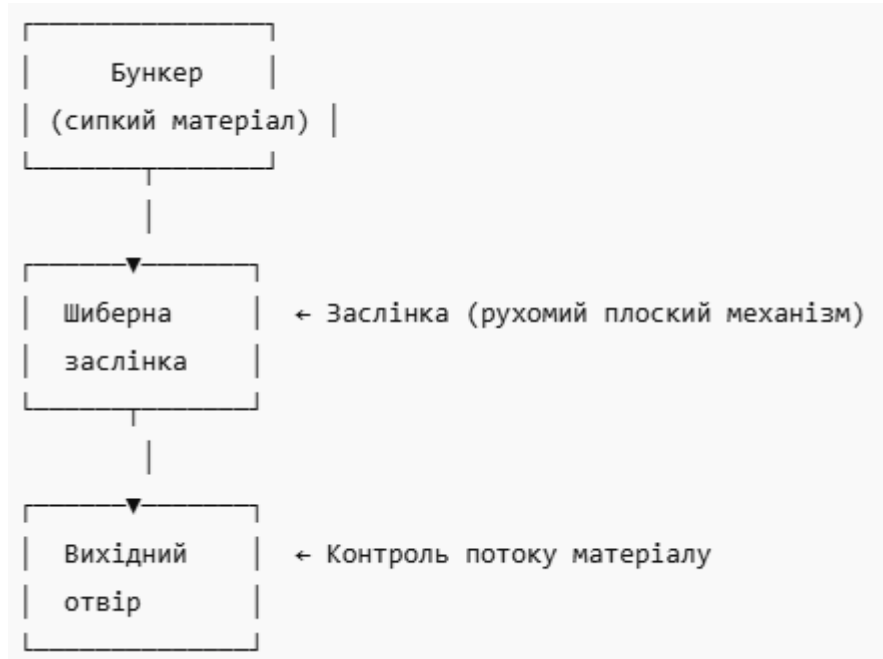
Рисунок 2.7 Схема роботи дозатора з шиберною заслінкою
