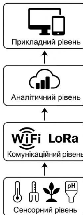
Рисунок 1.2 – Архітектура чотирирівневої IoT-системи для агросектору [7]
