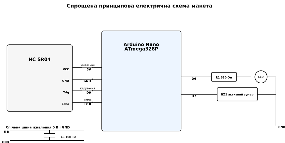
Рисунок 2.3 – Спрощена принципова електрична схема пристрою
