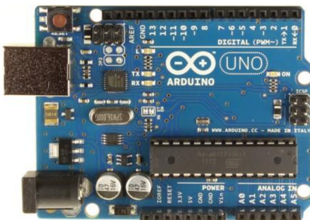
Рисунок 1.3 – Плата Arduino Uno як приклад мікроконтролерної основи пристрою [9]
