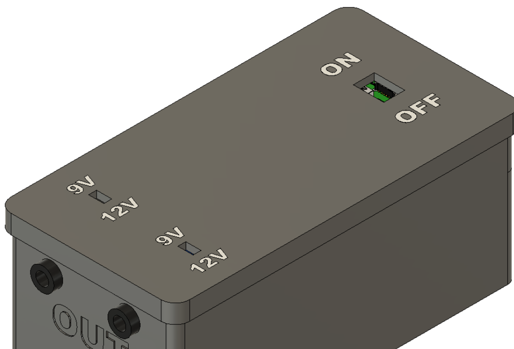
Рисунок 3.18 – Розміщення перемикачів вихідної напруги та кнопки вмикання на кришці пристрою
