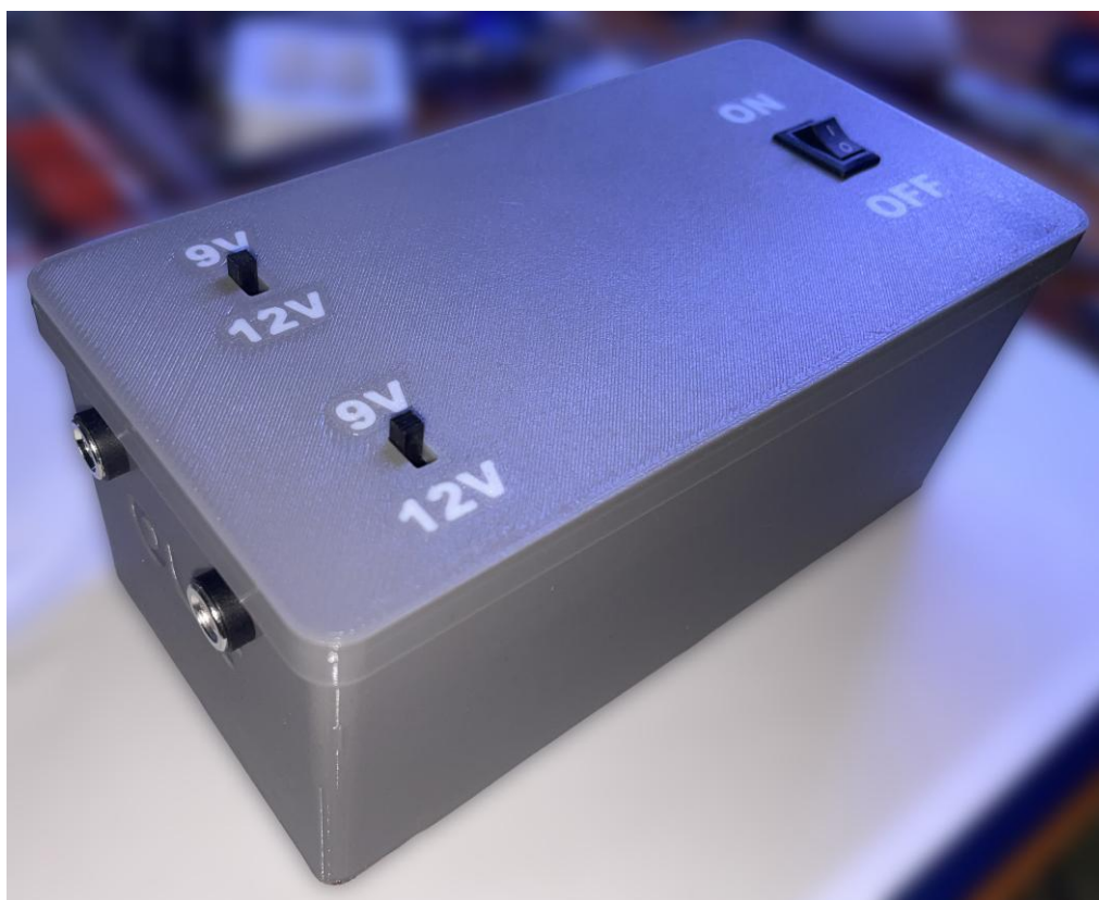
Рисунок 3.29 – Готовий вигляд безперебійного блока живлення для мережевого обладнання
