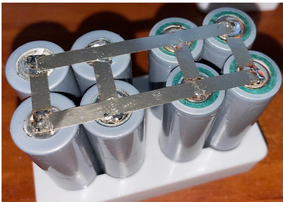
Рисунок 3.20 – З'єднання акумуляторних груп у послідовно-паралельну збірку
