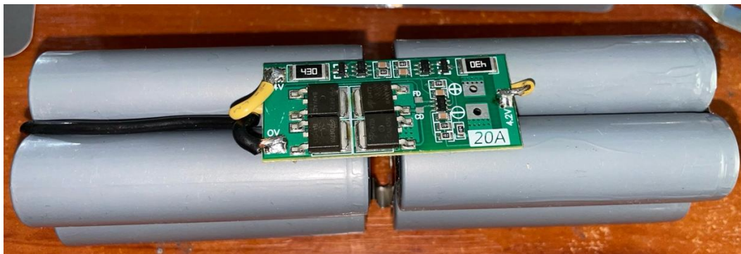
Рисунок 3.21 – Підготовлена акумуляторна збірка перед підключенням плати захисту
