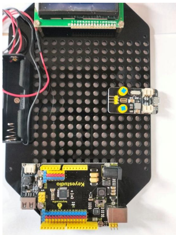
Рисунок 3.3 – Монтаж модуля живлення літійової батареї та модуля заряджання.
