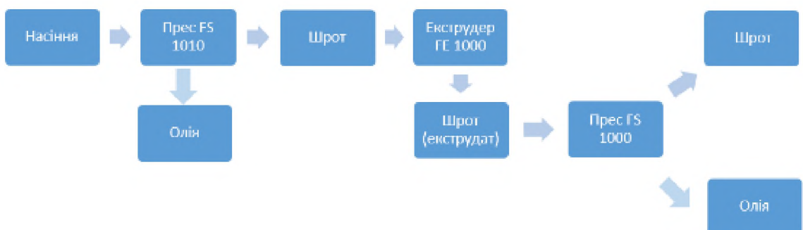
Рисунок 1.7 - Схема дворазового пресування насіння із екструзією.
