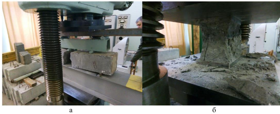
Рисунок 7.12 Випробування на міцність: а – зразка-призми; б -зразка-куба
