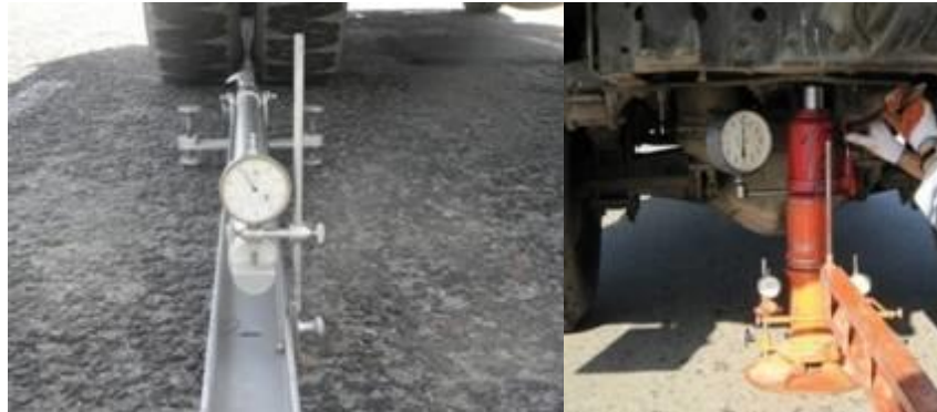
Рисунок 7.3 Випробування балкою Бенкельмана
