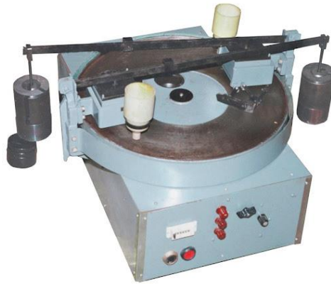
Рисунок 7.18 Лабораторне коло стирання ЛКІ-3
