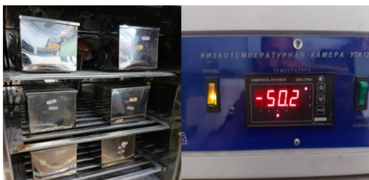
Рисунок 7.15 Проведення дослідження на морозостійкість
