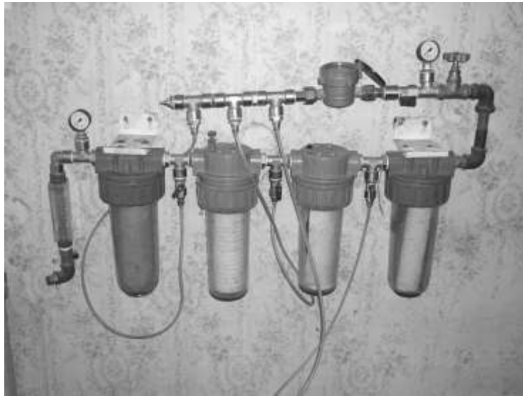
Рисунок 4.9 – Загальний вигляд установки для визначення проникливості пористого матеріалу
