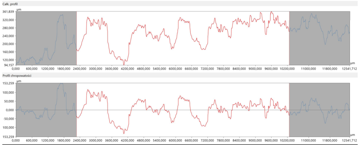
Рисунок 3.9 – Профілограма покриття, синтезовано в електроліті 20 г/л КОН+20 г/л р.с.+20 г/л Ca(OH) 2 +20 г/л Na 6 P 6 O 18 + 20 г/л Na 4 P 2 O 7 + 20 г/л діатоміту (див. таблицю 2.1, режим № 12)
