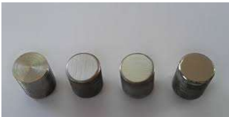
Рисунок 2.3 – Зразки сталі 100CrMnSi6 для мікроаналізу
