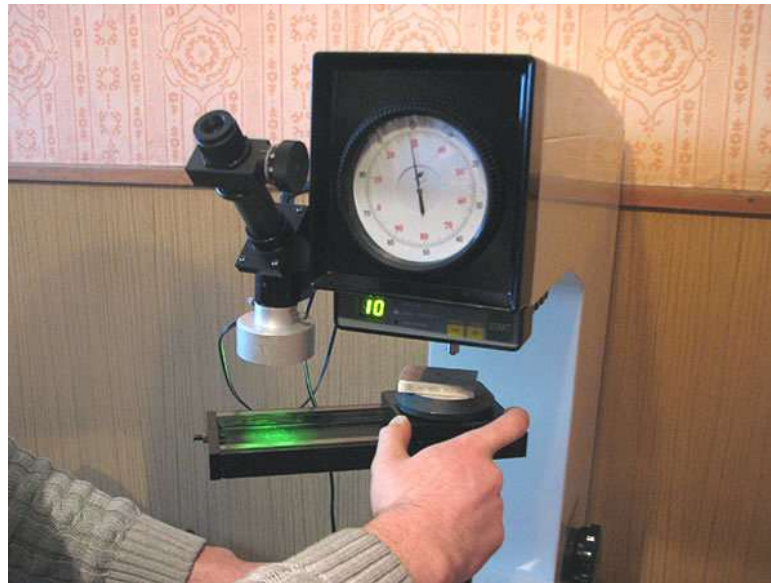
Рисунок 2.5 – Вимірювання твердості на твердомірі NOVOTEST TC-BPV
