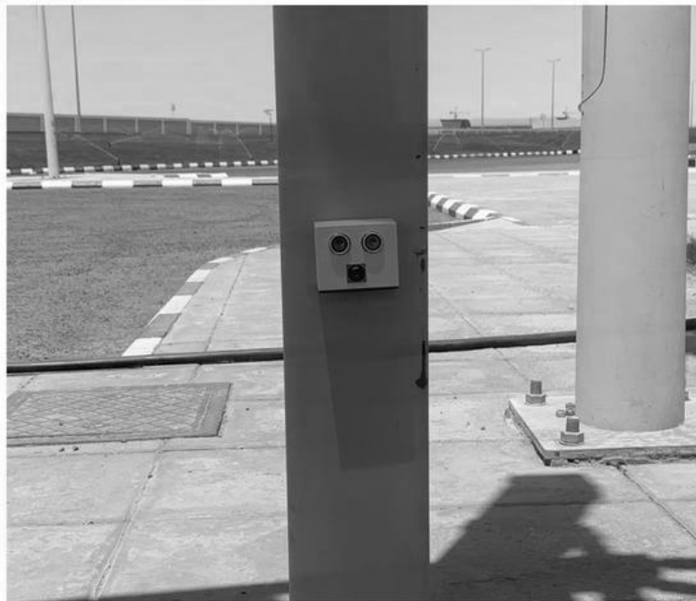
Рисунок 1.7 – Моніторинг за допомогою датчика далекоміра [13]
