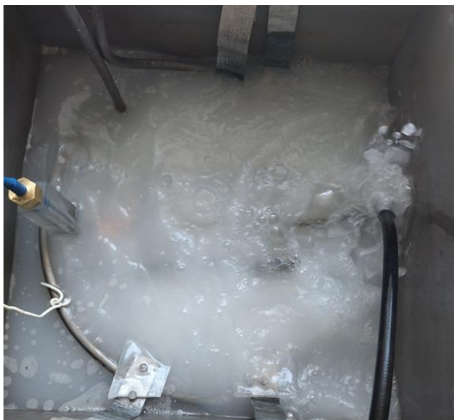
Рисунок 3.2 – Синтез ОКП методом ПЕО у присутності електроліту, що містить \text{Ca}(\text{OH})_2
