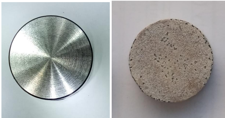
Рисунок 3.3 – Титановий сплав ВТ 6 до поверхневої обробки (а) та після синтезу в електроліті з \text{Ca}(\text{OH})_2 (б)
