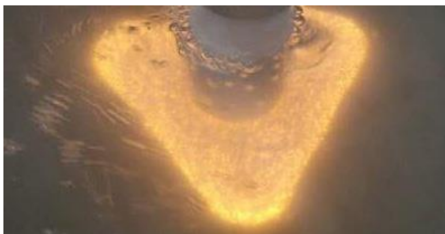
Рисунок 4.2 – Компонент, занурений в електроліт - високий потенціал, створений струмом в електроліті, створює плазмовий розряд на поверхні підкладки
