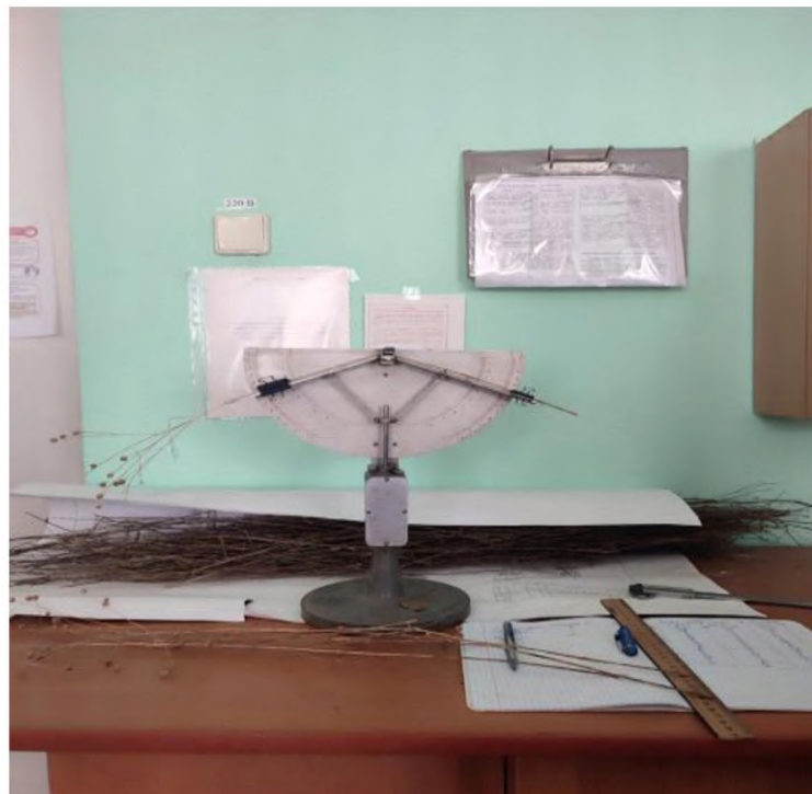
Рисунок 3.8 – Прилад для зламування трести льону: 1 – опора; 2 – механізм переміщення планок; 3 – градусований сектор; 4 – планки; 5 – досліджувана треста; 6 – стебло трести
