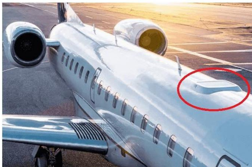
Рисунок 3.2 – Зовнішній вигляд авіаційного терміналу ESIM [13]
