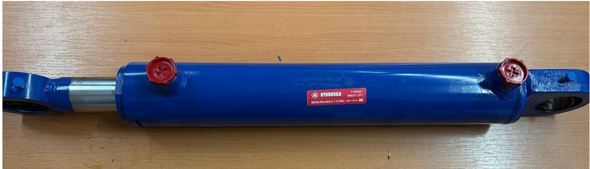
Рисунок 13.2 – Натурний зразок гідроциліндра Hydrosila MC80/50x400-3.11(765), використаний у лабораторній роботі
