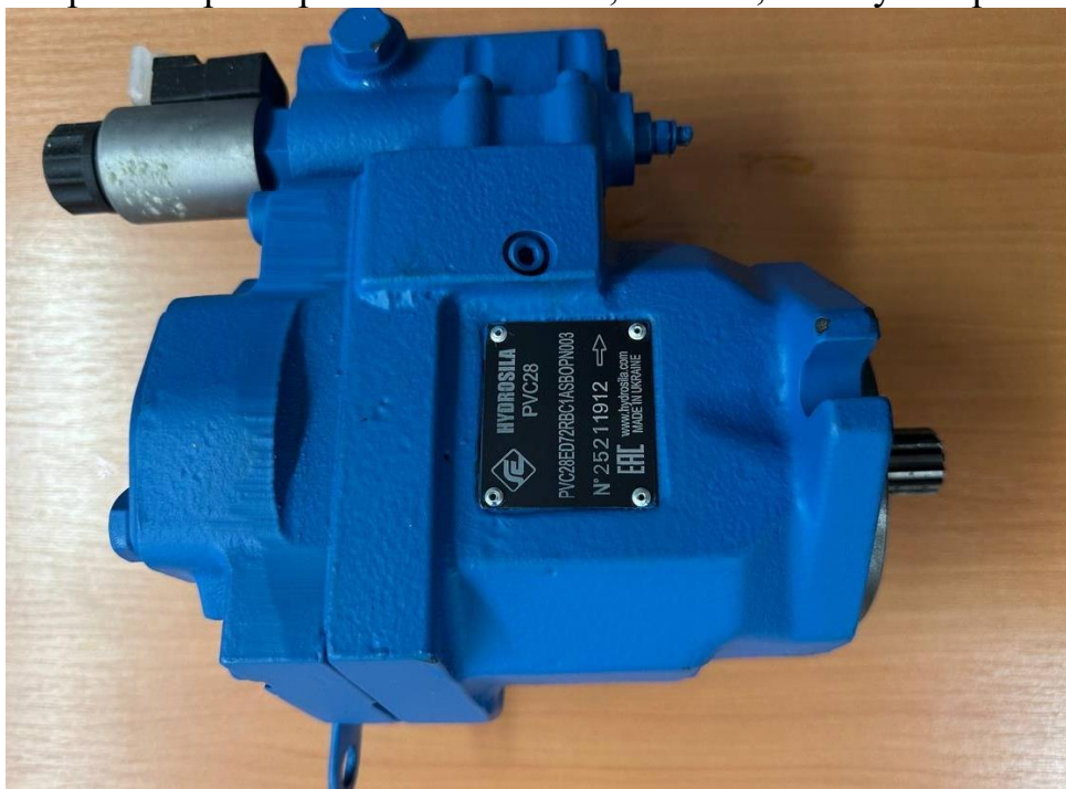
Рисунок 11.1 – Натурний зразок регульованого аксіально-поршневого насоса Hydrosila PVC28
