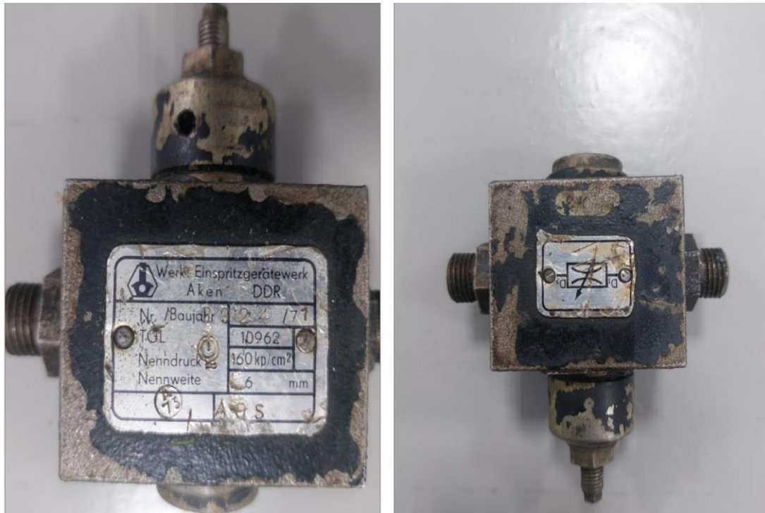
Рисунок 16.2 – Додатковий натурний зразок чорного дроселя TGL: табличка та гідравлічний символ
