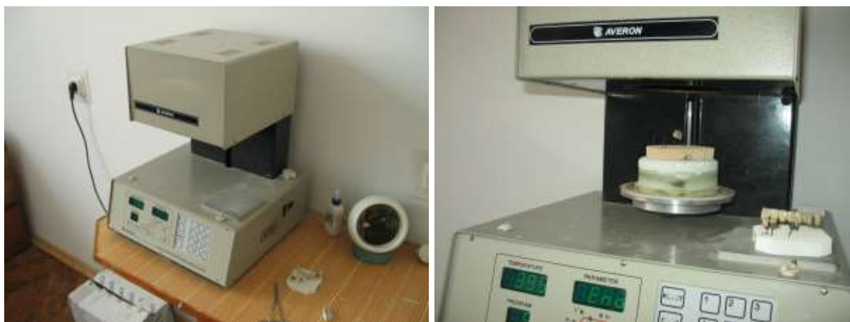
Рисунок 2.6 – Вакуумна піч "Averon" для відпалу кераміки
