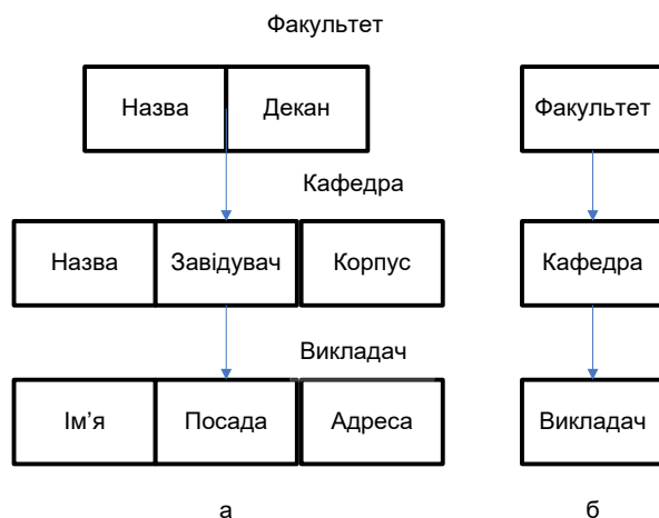
Рисунок 2.4 – Графічне зображення схеми ієрархічної структури даних: а – з уточненням; б – без уточнень
