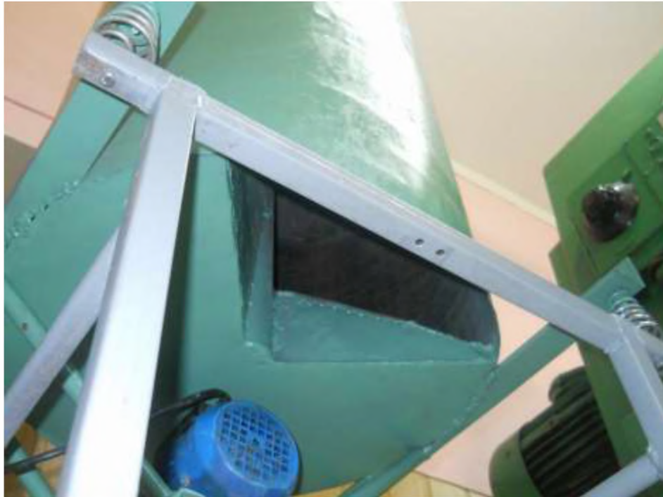
Рис. 3.6 Вивантажувальне вікно сушильної камери
