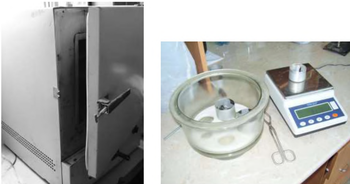
Рисунок 3.2. Обладнання, яке використовувалось у дослідженнях: сушильна електрошафа СНОЛ – 3,5.3,5.3,5/3 ИЗ; лабораторні ваги ТВЛ 0,5; бюкси
