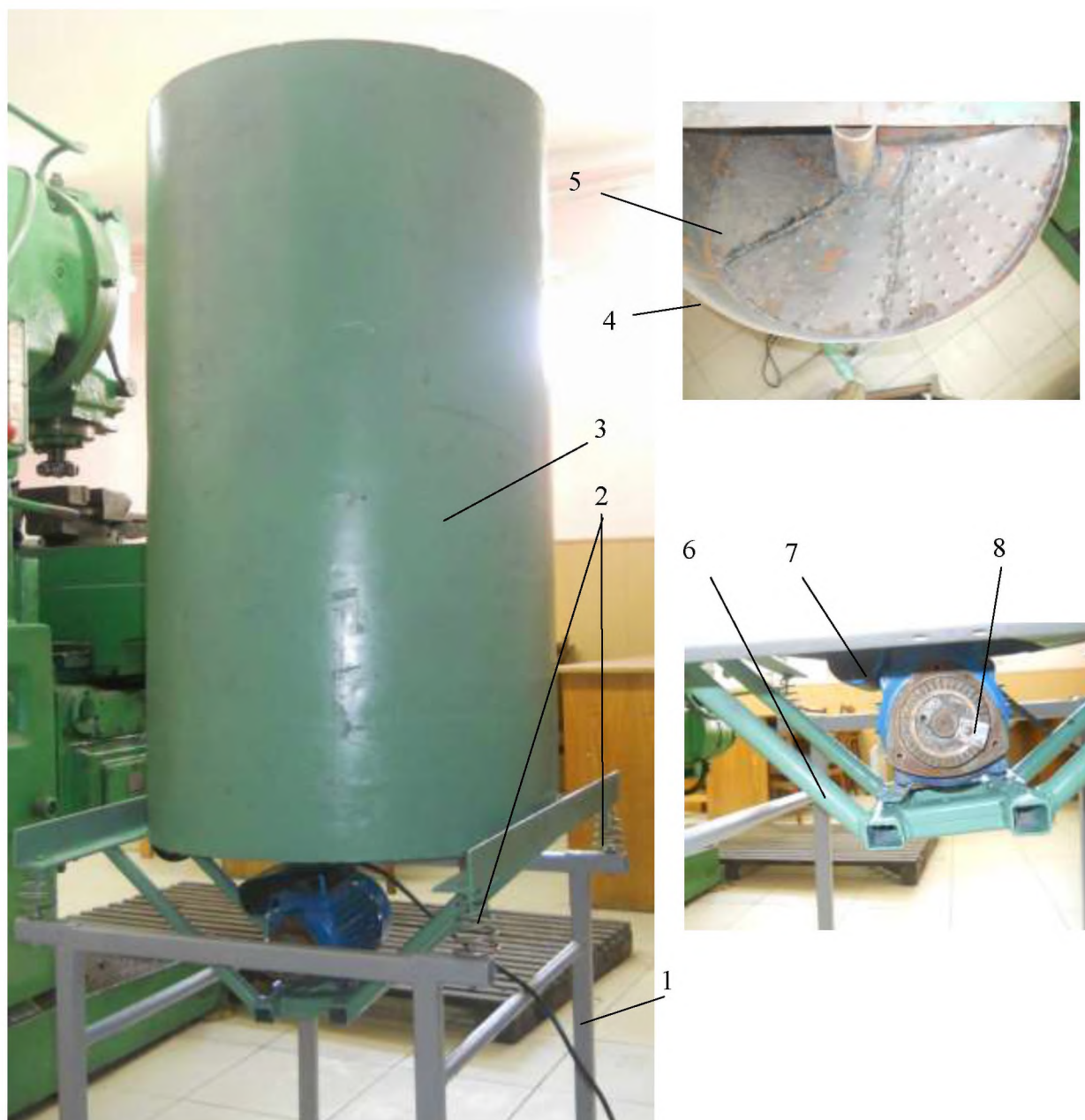
Рисунок 3.3. Експериментальна установка грануюче-сушильної камери: 1 – рама; 2-пружини; 3 – грануюче-сушильна камера; 4 – корпус; 5 – гвинтова поверхня; 6 – рама двигуна; 7 – електродвигун; 8 – ексцентрик
