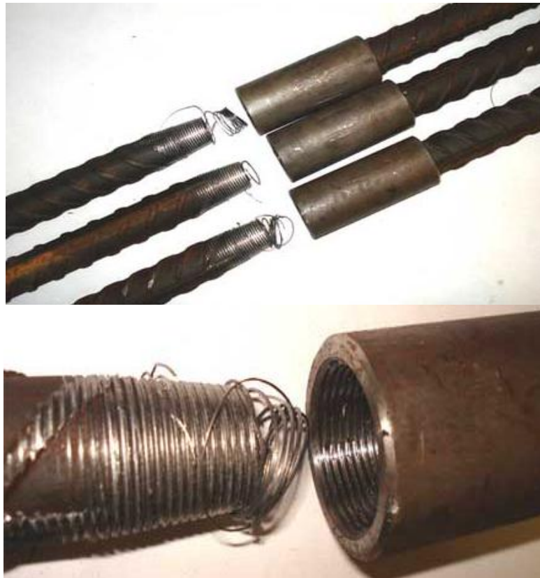
Рис. 6.5. Стикові з'єднання арматурних стержнів з конічною різьбою після розриву
