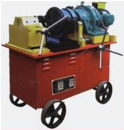
Рис. 6.9. Різбонакатний верстат РНС-40
