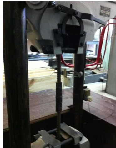
Рис. 6.15. Загальний вид випробувань з'єднань арматурного прокату з обтискною муфтою
