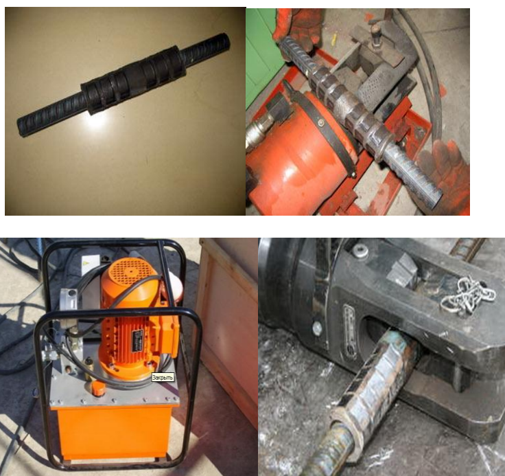
Рис. 6.12. Стикування арматури гідравлічним пресом GT 40
