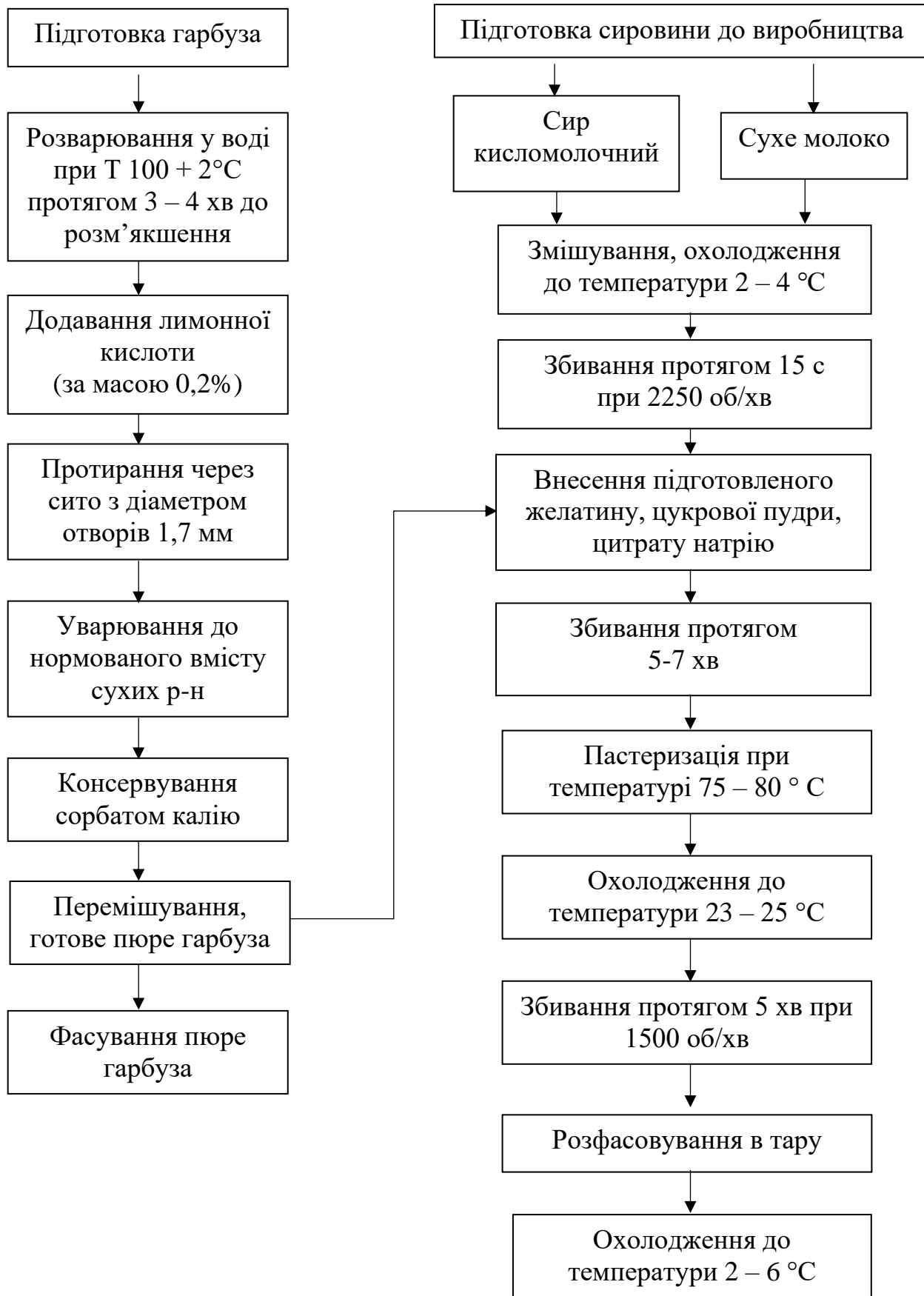
Рисунок 4.1 – Загальна технологічна схема виробництва мусу сиркового з додавання пюре гарбуза
