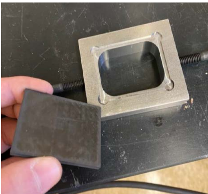
Рисунок 2.2 – Зображення зразка РЕЕК/СF та тримача зразка з нержавіючої сталі.
