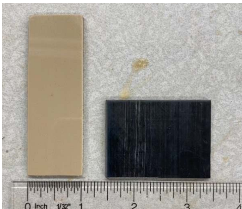
Рисунок 2.1 — Зображення зразкових пластин РЕЕК (ліворуч) та РЕЕК/CF (праворуч); масштаб — лінійка.
