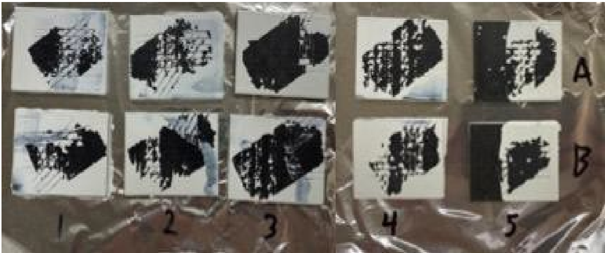
Рисунок 3.11 – Зображення результатів адгезійного тесту стрічкою для зразків РЕЕК/CF, відшліфованих за різних швидкостей обертання. Швидкості 1...5 відповідають 4 000, 6 000, 8 000, 10 000 та 12 000 об/хв. А та В – копії ідентично оброблених зразків.
