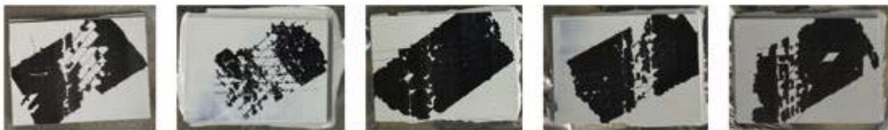
Рисунок 3.9 – Зображення результатів адгезійного тесту стрічкою для базового експерименту РЕЕК/CF без експериментальної обробки. Оцінки зразків зліва направо: 4, 4, 2, 3, 3.
