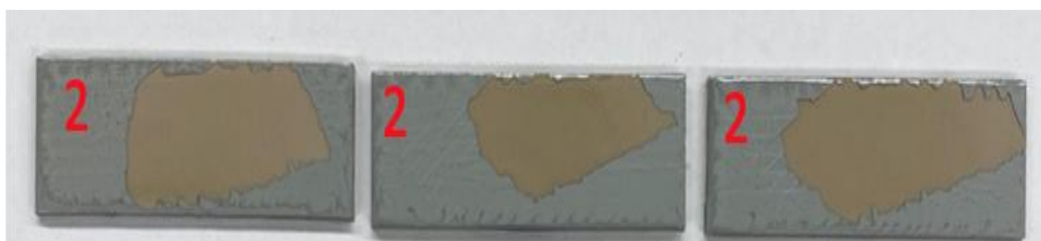
Рисунок 3.3 – Результати адгезії для РЕЕК, покритого епоксидом після шліфування без додаткової обробки. Оцінки за тестом стрічкою наведені червоним кольором.
