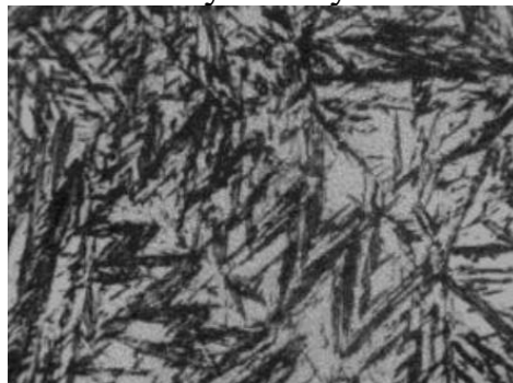
Рисунок 4 – Структура доевтектоїдної сталі після гартування за завищених температур
