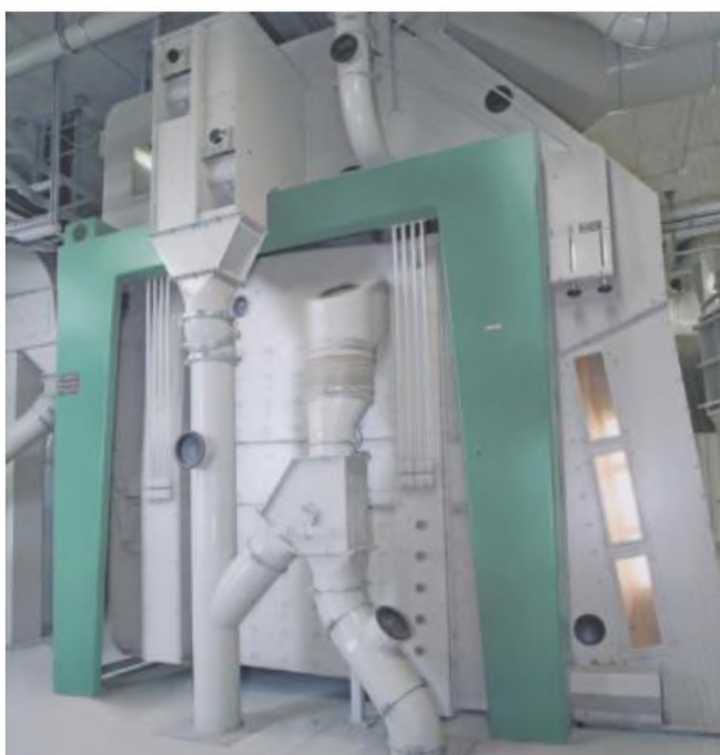
Рисунок 1.2 – Зовнішній вигляд та функціональна схема зерноочищувальної машини серії Schmidt-Seeger TAS™
