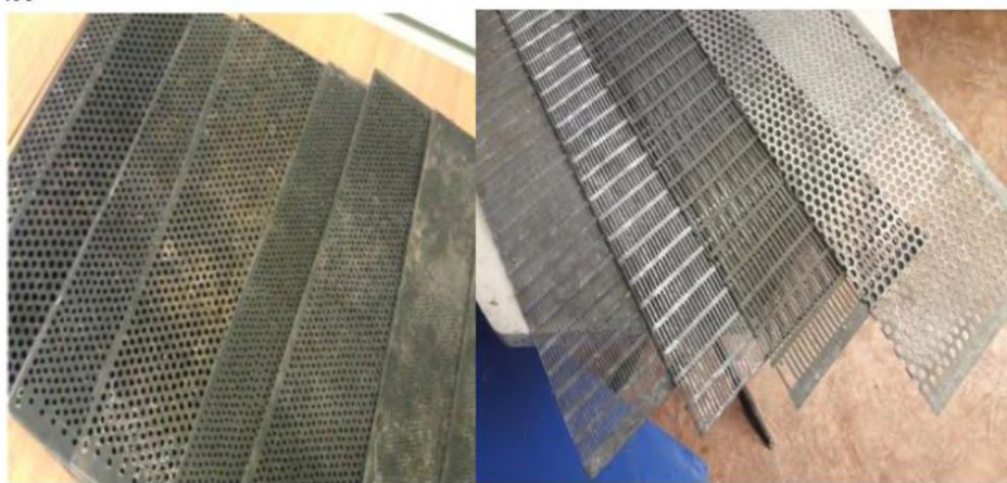
Рисунок 3.2 – Стандартний блок решіт (б) і модернізований (а), виготовлений з полімерного матеріалу
