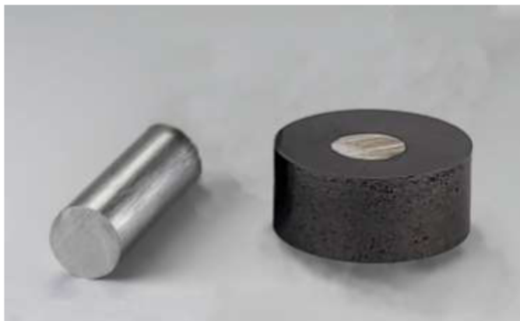
Рисунок 2.2 – Форма зразків для мікроаналізу, окремо та залитих бакелітом
