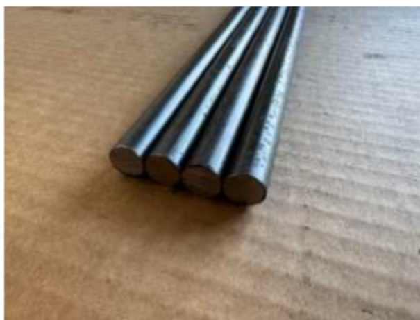
Рисунок 2.1 – Стрижні, відрізані від прокату сталі 65Г
