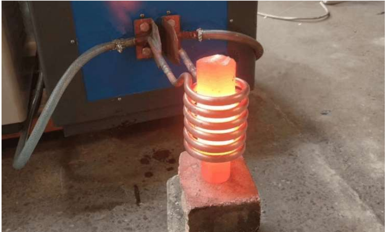
Рисунок 2.6 – Нагрів зразка в індукторі
