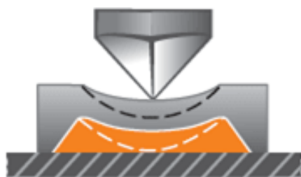
Рис. 15. Схема вимірювання властивостей мембрани і експериментальна крива навантаження-розвантаження: жорсткість і прогин мембрани (а), мембрана випирає в підкладку (б)
