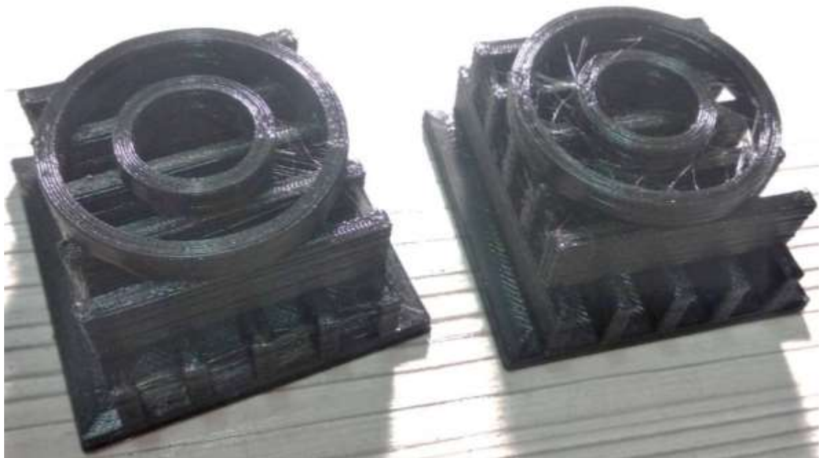
Рисунок 4.7 – Деталь надрукована з температурним контролем.
