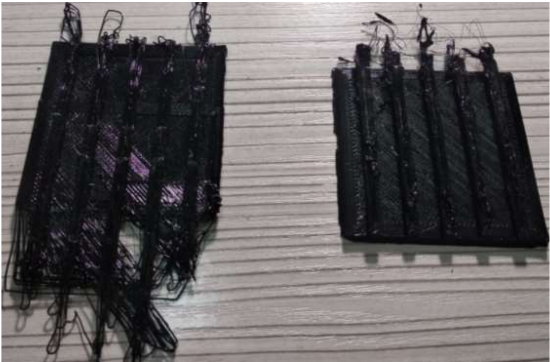
Рисунок 4.7 – Деталь надрукована без температурного контролю.
