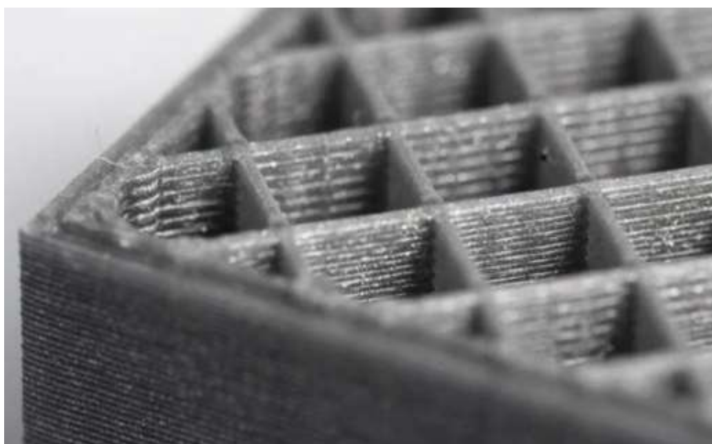
Рисунок 1.12 – Проміжки між заповненням і контуром виробу
