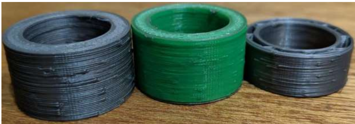
Рисунок 1.9 – Краплі та горбки на поверхні виробу
