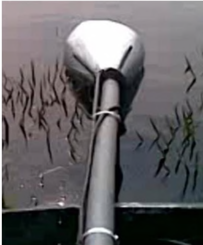
Рисунок 4.1 Фото розробленого пневмомеханічного змішувача забірною пристрою засобу для добування сапропелю
