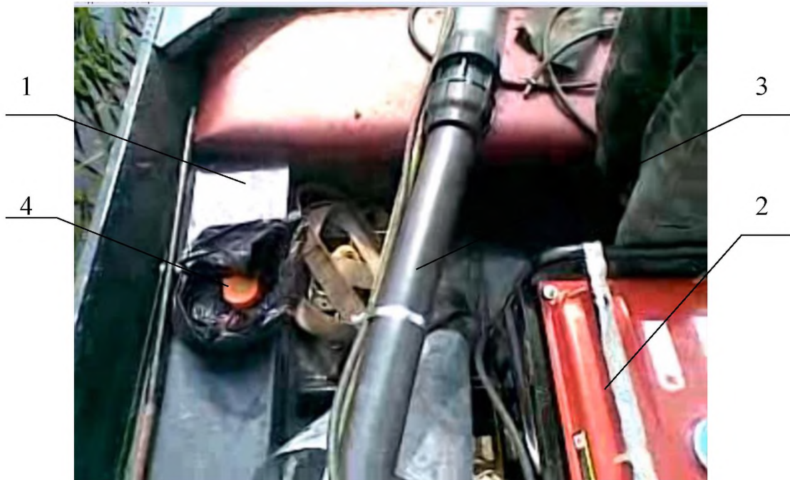
Рисунок 3.4. Фото випробувань забврного пристрою: 1 – плавзасіб, 2 – генератор, 3 – забірний пристрій, 4 – глибиномір (вимірювальна рулетка)
