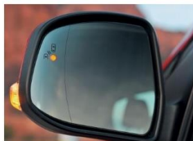
Рисунок 12 – Додатковий сектор і індикатор системи BLIS в дзеркалі Ford
