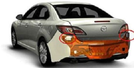
Рисунок 8 – Розташування датчиків системи Blind Spot Monitoring
