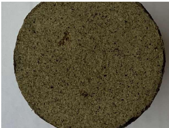
Рис. 3.4. Макроструктура біокомпозиту з оптимальним вмістом компонентів та підвищеною тривалістю термічної обробки
