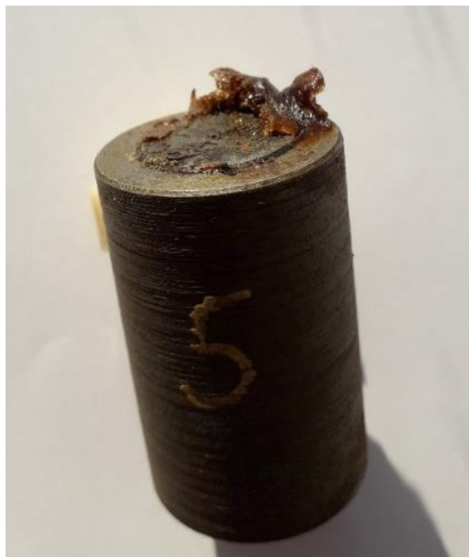
Рис. 2.17. Загальний вигляд пресформи після термічної обробки
